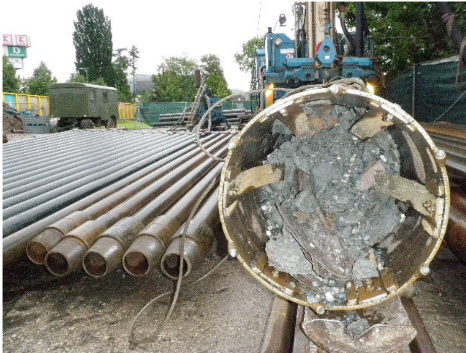
Vrtné nářadí upravené pro těžení železných centrátorů výstroje a výsypů z kaveren
